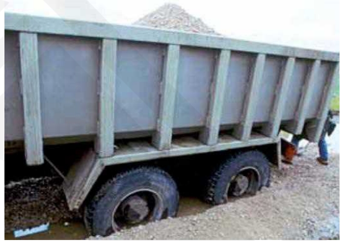
ناپایداری بستر (راست) و بهبود آن با ژئوگرید (چپ)
